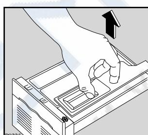
Стиральный порошок скапливается в углублении дозатора. Для чистки углубления можно использовать старую зубную щетку. После чистки установите дозатор на место, и включите программу стирки без белья.
